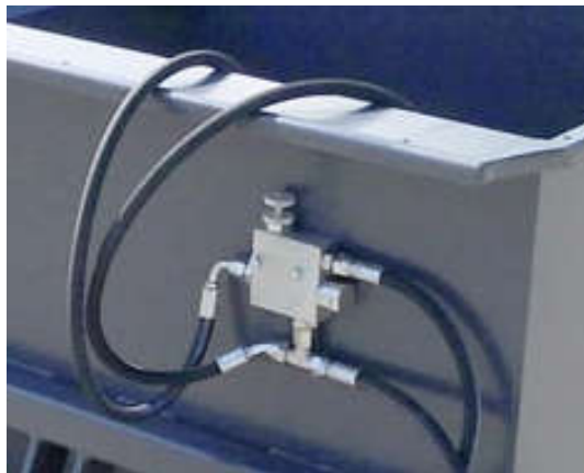
Bild 1 – Installation av ventil kopplad till en ST-1000 och ST-1250 sandspridare
