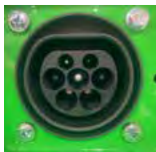
Standard Typ 2 ladduttag på lastaren
