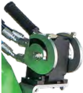
Multikoppling på lastaren A34366
